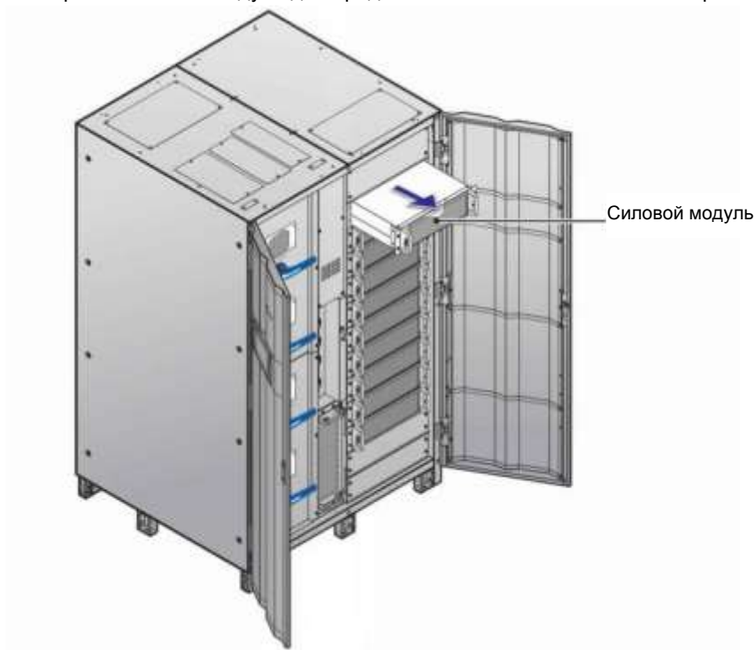
Рисунок 5-40: Демонтаж силового модуля
