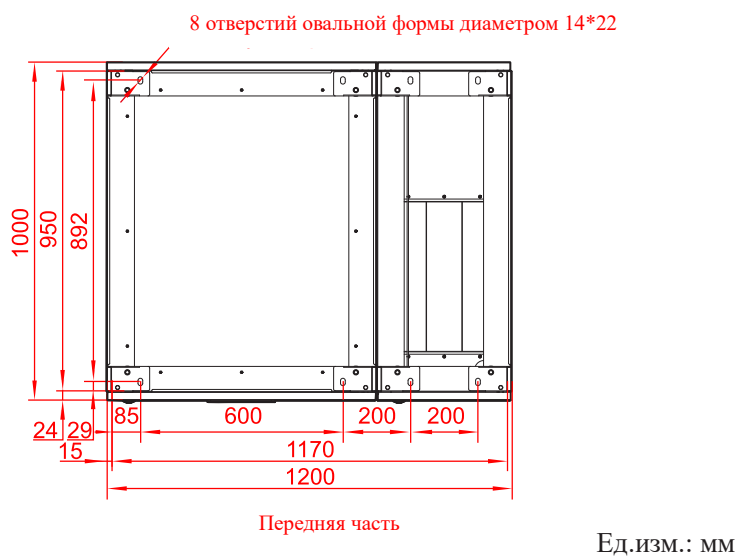
Рисунок 3-12 Рама ИБП с установочными отверстиями для ИБП VGD-II-400M33HP-100, VGD-II-500M33HP-100, VGD-II-600M33HP-100 (конфигурация с нижней проводкой).
