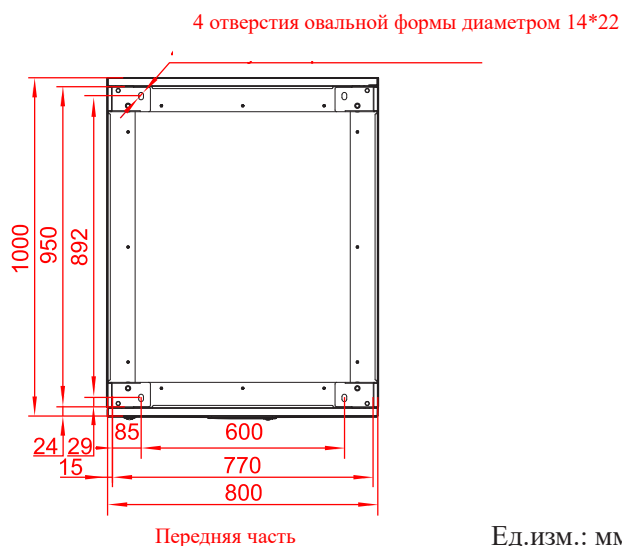
Рисунок 3-11 Рама ИБП с установочными отверстиями для ИБП VGD-II-400M33HP-100P, VGD-II-500M33HP-100, VGD-II-600M33HP-100.
